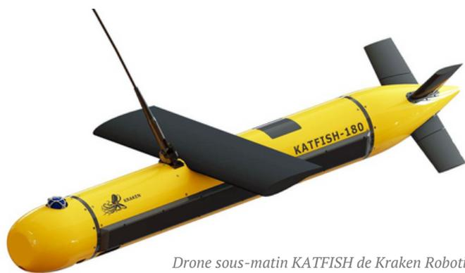
*Drone sous-marin KATFISH de Kraken Robotics embarquant un dispositif ATR.
